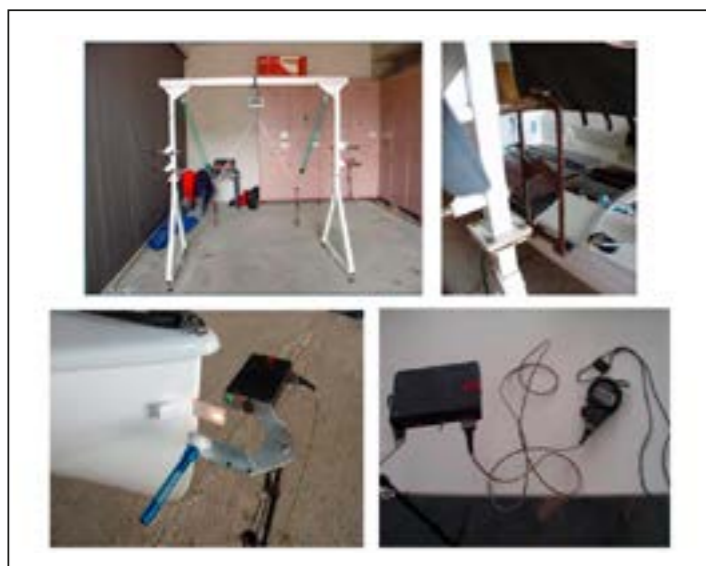
Рис. Н.4.2.1. Современная система для теста Лэмбулли швертбота «Финн». Показаны: пара выдвижных ножевых призматических опор, скобы-захваты для «Финна» с разнесением точек подвеса на 200 мм и фотоэлемент для фиксации процесса качаний.
