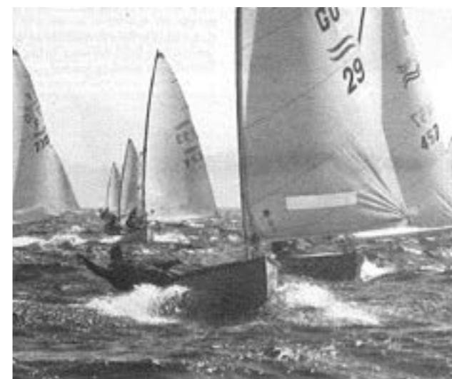
Рис. 8 Финн идет полным курсом в сильный ветер. Слишком сильный ветер, чтобы удержать парус, управляя им напрямую только за один ходовой конец. Гонщики рулят прямо и удерживают яхту, усиливая движение лодки. Если яхта накренилась под ветер, то шкоты отпускают, если на наветренную сторону, то добирают. (Фото: Ф.Ричард)
