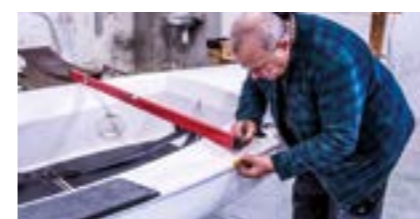
Измерение глубины кокпита на станции 2
