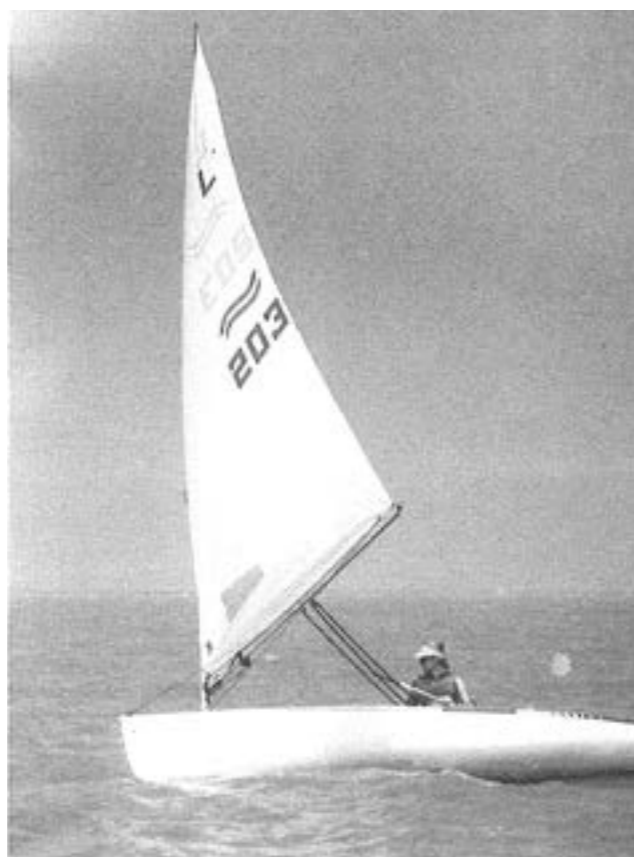
Рис. 7 Эсно Рехардт идет фордевиндом в среднем ветре. Поток воздуха реверсивный от задней шкаторины к мачте, но ламинарный, это можно увидеть, обратив внимание на колдунчики, расположенные между буквами «L». Эсно закрепил лодку на наветренную сторону, тем самым снизилась площадь смоченной поверхности. Он должен был ослабить оттяжку Каннингхэма, оттяжки галсового и шкотового угла, чтобы убрать складки у галсового и шкотового угла, тем самым улучшив форму нижней части паруса. Оттяжка гика не сильно добита, и поэтому выгнутая форма паруса и небольшое напряжение по задней шкаторине.
