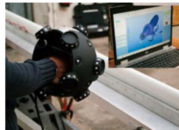
Сканирование мачты с лазерным сканером. Врезка: 3D-модель мачты на экране компьютера в режиме реального времени. Фото: Пол Иачкине, ENVSN.
