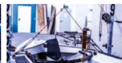
Масса корпуса 110,8 кг до установки корректирующих грузов
