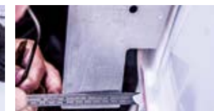
Проверка высоты линии борта
