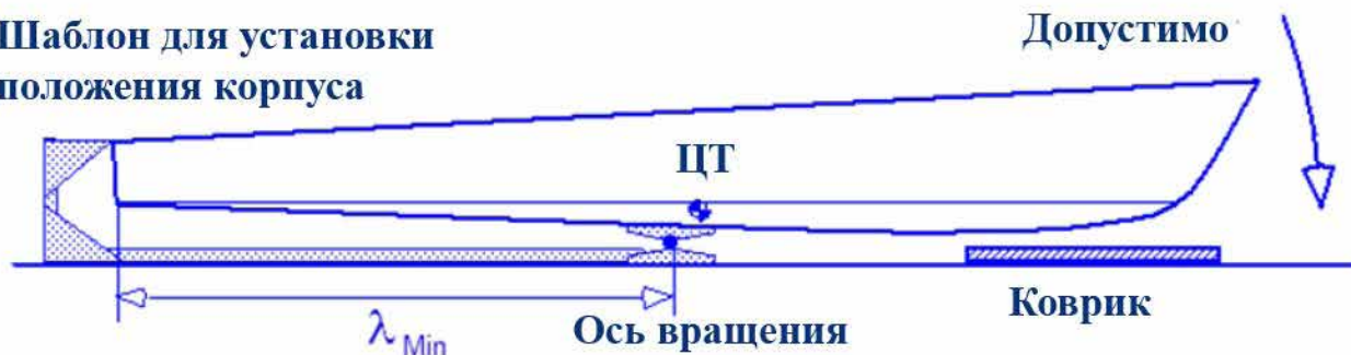
Рис Н.4.2. Тест на допустимое положение ЦТ. ЦТ расположен в нос от \lambda_{Min} .
