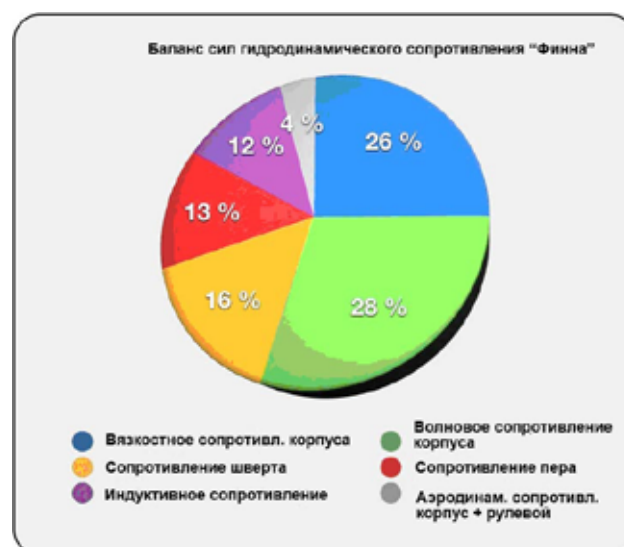
Баланс сил сопротивления движению «Финна» на остром курсе при ветре 18 узлов и мелкой зыби. Наибольший вклад вносит волновое сопротивление (28%, зеленый). Воздушное сопротивление лодки и рулевого самое маленькое, около 4% (серый).
