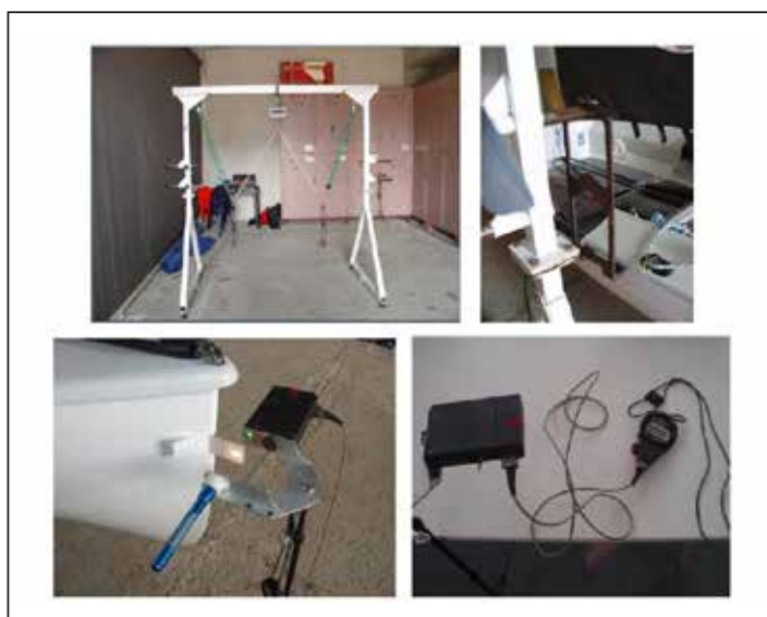
Рис. Н.4.2.1 (слева). Современная система для теста Лэмбоули швертбота «Финн». Показаны: пара выдвижных ножевых призматических опор, скобы-захваты для «Финна» с разнесением точек подвеса на 200 мм и фотоэлемент для фиксации процесса качаний.
