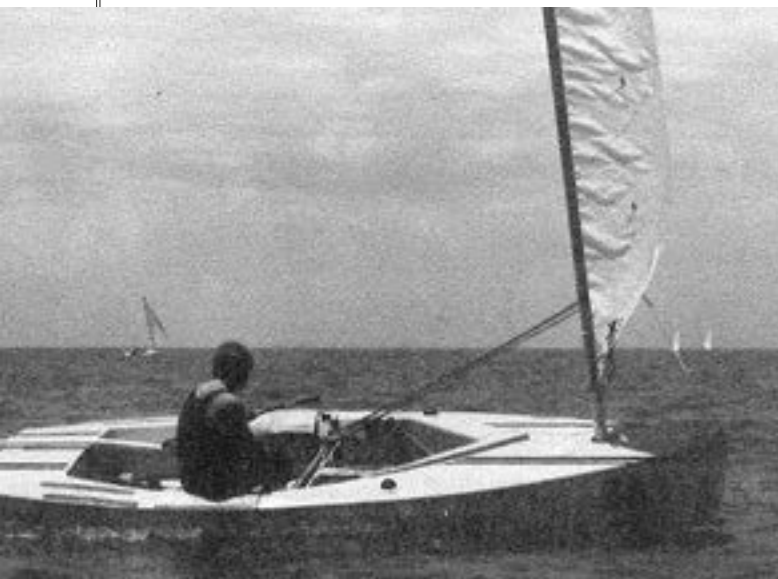
Рис. 13 Курс фордевинд, слабый и средний ветер, ламинарный поток ветра движется от задней шкаторины к мачте. Колдунчики указывают направление потока.
