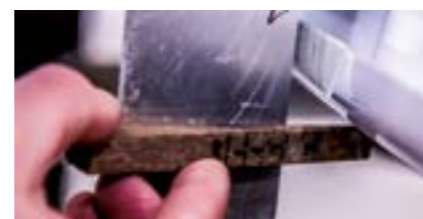
Проверка высоты линии борта
