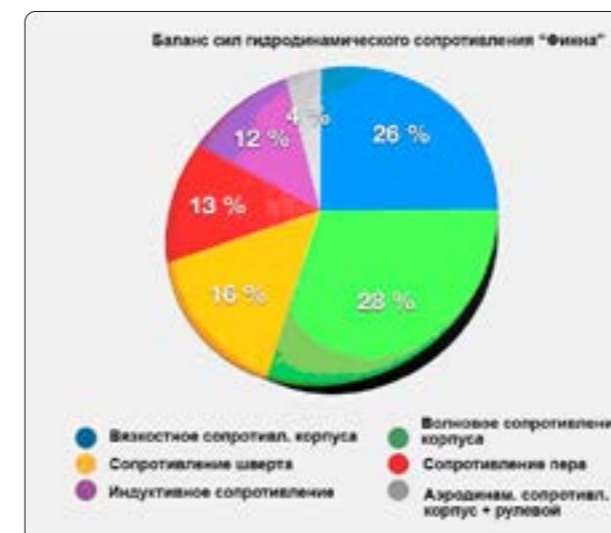
Баланс сил сопротивления движению «Финна» на остром курсе при ветре 18 узлов и мелкой зыби. Наибольший вклад вносит волновое сопротивление (28%, зеленый). Воздушное сопротивление лодки и рулевого самое маленькое, около 4% (серый).
