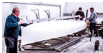
Установка продольного бруса для формирования базовой линии
