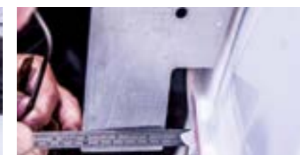
Проверка высоты линии борта
